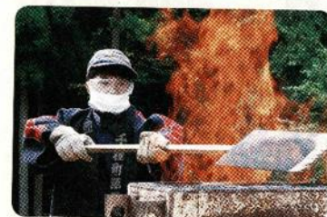
炉に砂鉄と木炭を交互に入れ加熱する(兵庫県六甲市)
