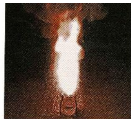
図50 酸化銅をアルミニウムと加熱したときの様子
