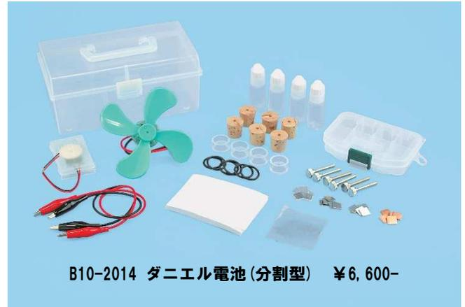
試薬 2-3 滴をろ紙にしみこませ、1cm 角の金属片で実験できる業界最小のダニエル電池
