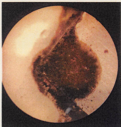
図 3 5 滴下直後の様子 (1.4%硫酸銅水溶液と Mg 片)
