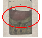
1 日反応させた亜鉛板の様子
