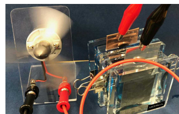
半透膜で溶液を隔て、少量の液で済むよう工夫している。
