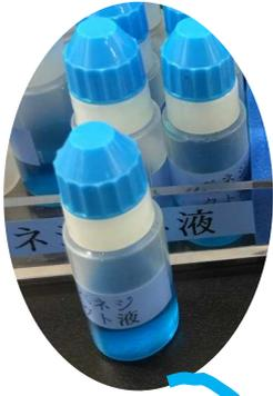
★ベネジクト液を入れてよく混ぜた後、試験管に入れかえて、加熱します。
